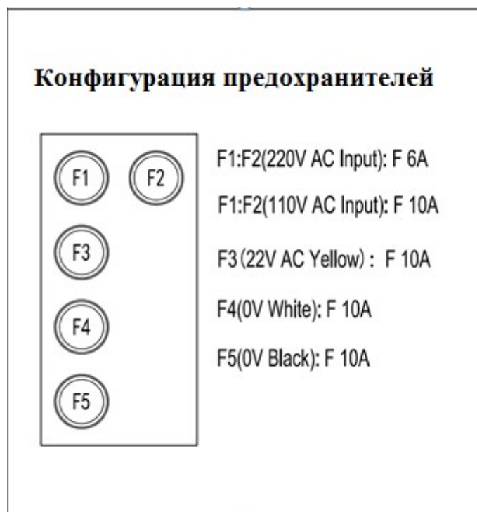
Рис. 6. Блок предохранителей напольного блока подключения
