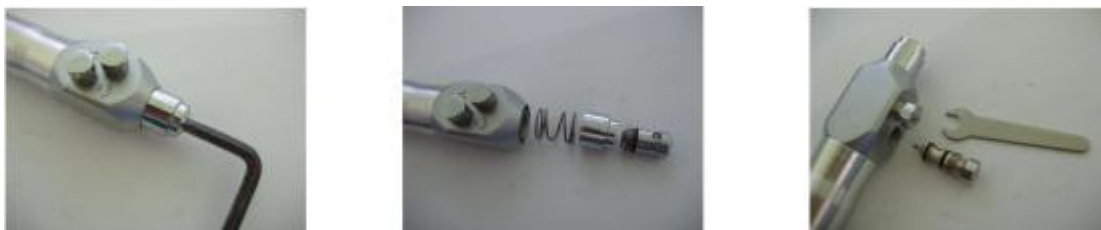
Рис. 30. Разбор прямого пистолета для очистки
