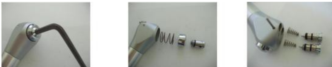
Рис. 29. Разбор углового пистолета для очистки
