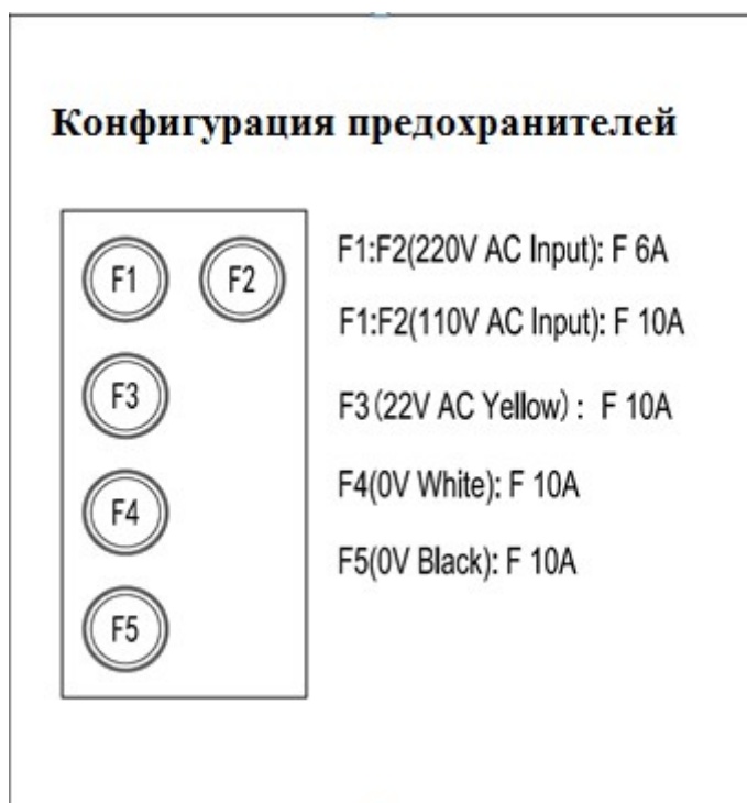
Рис. 5. Блок предохранителей напольного блока подключения
