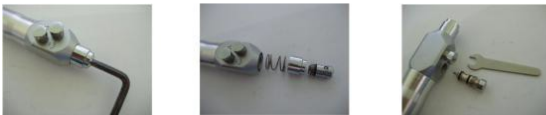
Рис. 27. Разбор прямого пистолета для очистки
