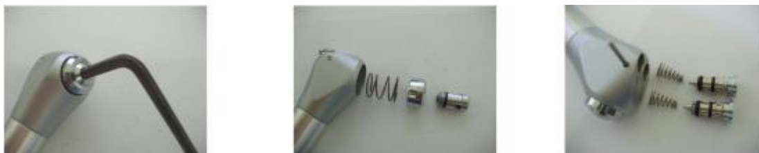
Рис. 26. Разбор углового пистолета для очистки
